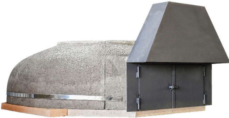
Assemblage du four avant isolation et habillage
